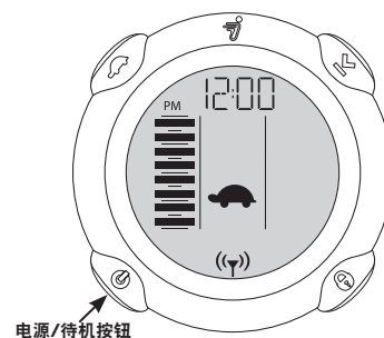
图 39：接通 PT 的电源
